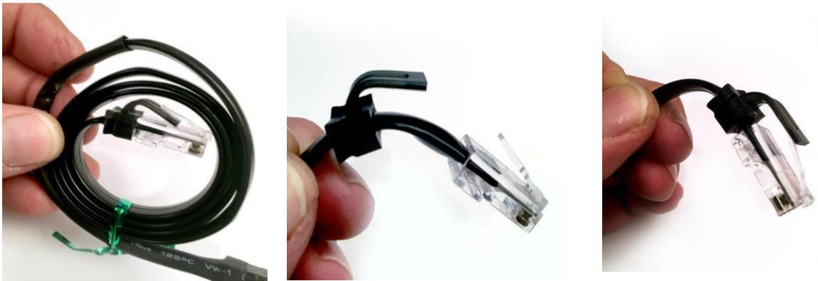
Der Neue Kabel ist ausgestattet mit einer speziellen Sicherung die ein Ablösen des Kabels während dem Flug verhindert. Um den Kabel sauber zu lösen bitte den kleinen Plastikschutz einfach einbischen zurückziehen.
